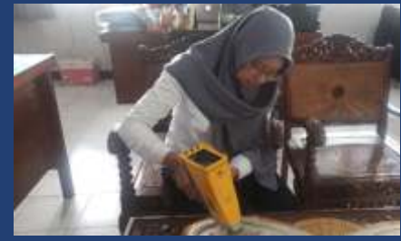
Pengujian sampel acian dengan XRF
